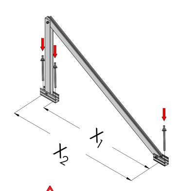
Tornilleria de anclaje no incluida. Anclaje mediante tornillo de hasta M10.
