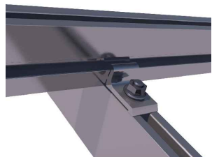
Detalle fijación G1 a triángulo (Son necesarios 2 fijaciones por perfil, 1 por cada lado)
